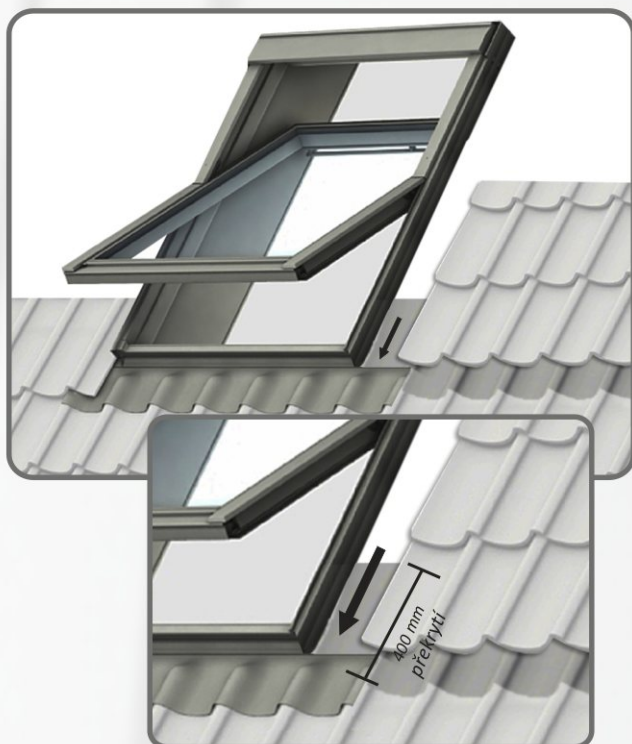
Montáž krytiny kolem střešního okna, obrázek č. K18
