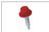
GT 3 - samovrtné šrouby s EPDM a pozink podl. Upevňování profil. plechů do ocelových konstrukcí. Tmax 3mm
