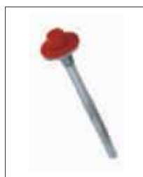
GT 12 SP - samovrtné šrouby s EPDM podložkou Upevňování sendvič. panelů do ocel. konstrukcí. Tmax 12mm
