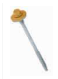
GT 6 SP - samovrtné šrouby s EPDM podložkou Upevňování sendvič. panelů do ocel. konstrukcí. Tmax 6mm
