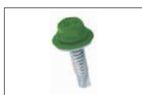
GT 6 - samovrtné šrouby s EPDM a pozink podl. Upevňování profil. plechů do ocelových konstrukcí. Tmax 6mm
