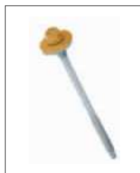
GTW 6 SP - samovrtné šrouby s EPDM podložkou Upevňování sendvič. panelů do beton. konstrukcí. Tmax 6mm
