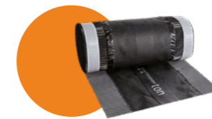
Hřebenový větrací pás RBF vent z vysoce kvalitního hliníku, perforované polypropylenové textilie a silného butylového lepidla (červená U03 / černá U06 / šedá U07 / hnědá U11) 0,39 x 5 m
