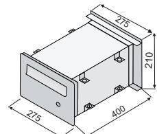
Schránka určená pro nazdění do zdi nebo plotového sloupu o tloušťce 400 mm
