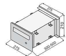
Schránka určená pro nazdění do zdi nebo plotového sloupu o tloušťce 300-500 mm
