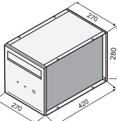
Schránka určená pro nazdění do plotového sloupu z tvarového betonu
