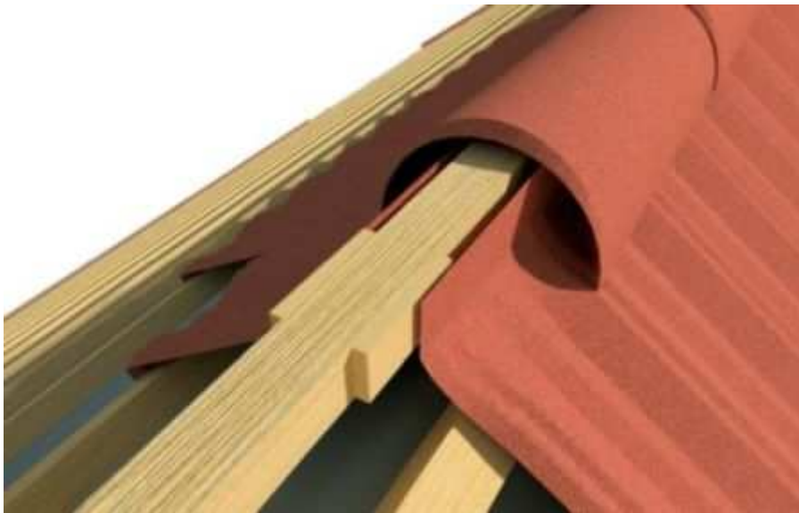
Montáž hřebene - celkový pohled
