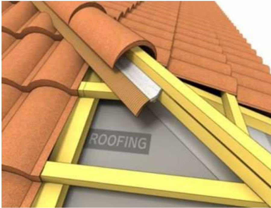
Montáž nároží u profilu Římská - celkový pohled
