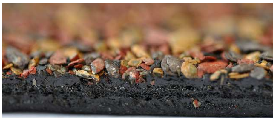
Obr. 04 Řez asfaltovým pásem pro použití jako vrchní vrstva hydroizolačních souvrství střeš. Na povrchu hrubozrnný minerální posyp. V řezu je zřetelná nosná vložka asfaltové krycí hmoty.
