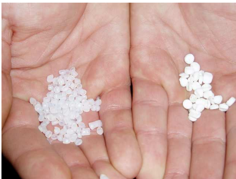
Obr.05 Vlevo granulát APP modifikátoru, vpravo SBS modifikátor
