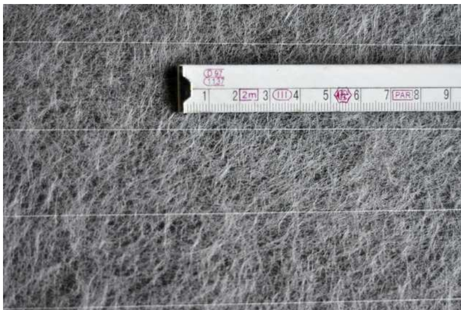
Obr. 08 Detail vložky ze skleněné rohože
