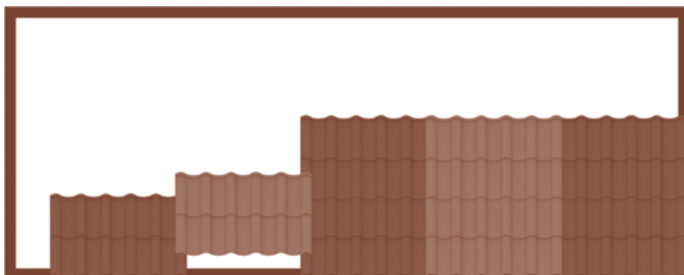
Doporučený postup pokládky od okapové hrany zprava
